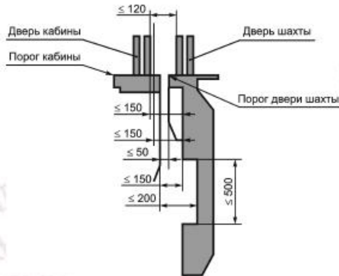
Рисунок 3 — Расстояние между элементами кабины и шахты
